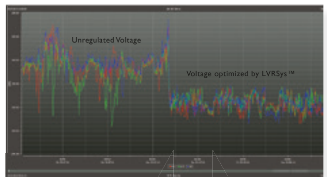
Tensão não regulada comparada com a tensão otimizada pelo sistema LVRsSys™
