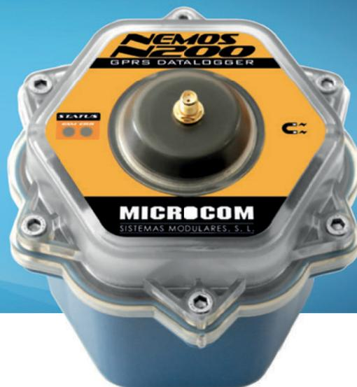
O NEMOS N200 é um dispositivo de aquisição de dados com comunicação GPRS e alimentação a bateria especificamente desenvolvido para operar em locais sem energia e ambientes suscetíveis a inundações (grau de proteção IP68). Possui quatro entradas digitais a impulso para caudalímetros e duas entradas analógicas.
